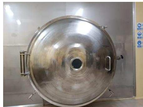
Maquina Liofilizadora: Abierta (izq.) Cerrada (derecha). Fuente: Elaboración Propia.
